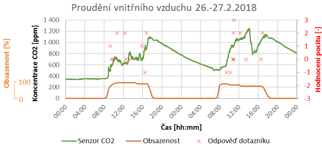
Obr. 78: Výšek dvou dnů z průběhu koncentrace CO 2 a obsazenosti prostoru v konfrontaci s odpověďmi dotazníkového průzkumu - proudění vnitřního vzduchu
