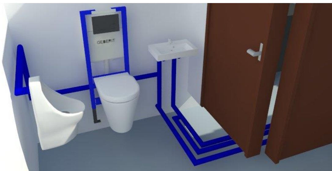
Obrázek 7: ukázka změn směru, napojování a jednotná dimenze včetně izolace Zdroj: vlastní tvorba
