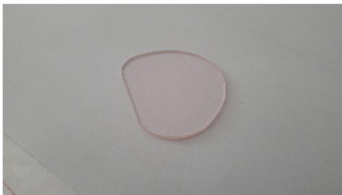
Obr. 36. Wafer silikátového sklo GZ4s obsahem erbia, ytterbia a zinku
