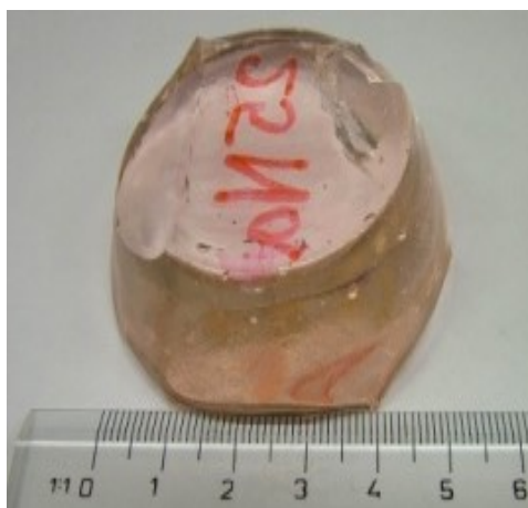
Obr. 35. Silikátové sklo GZ4s obsahem erbia, ytterbia a zinku (převzato z [94])
