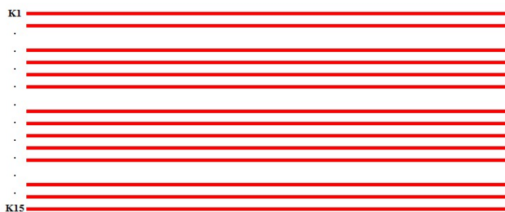
Obr. 37. Schéma uspořádání šterbin na litografické masce
