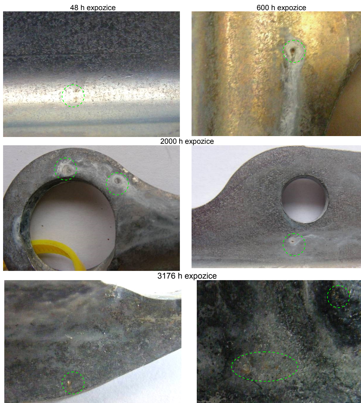
Obrázek 110 – Příklady bodového napadení Zn/Ni povlaku
