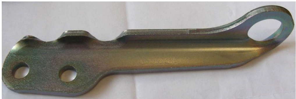
Obrázek 107 – Průběh korozního napadení povrchové úpravy vzorků L
