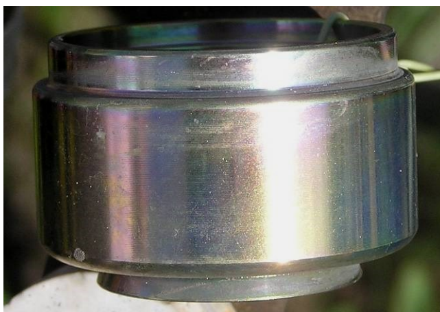
Obrázek 83 - Korozní napadení vzorku C po 3 měsících expozice na atmosférické stanici
