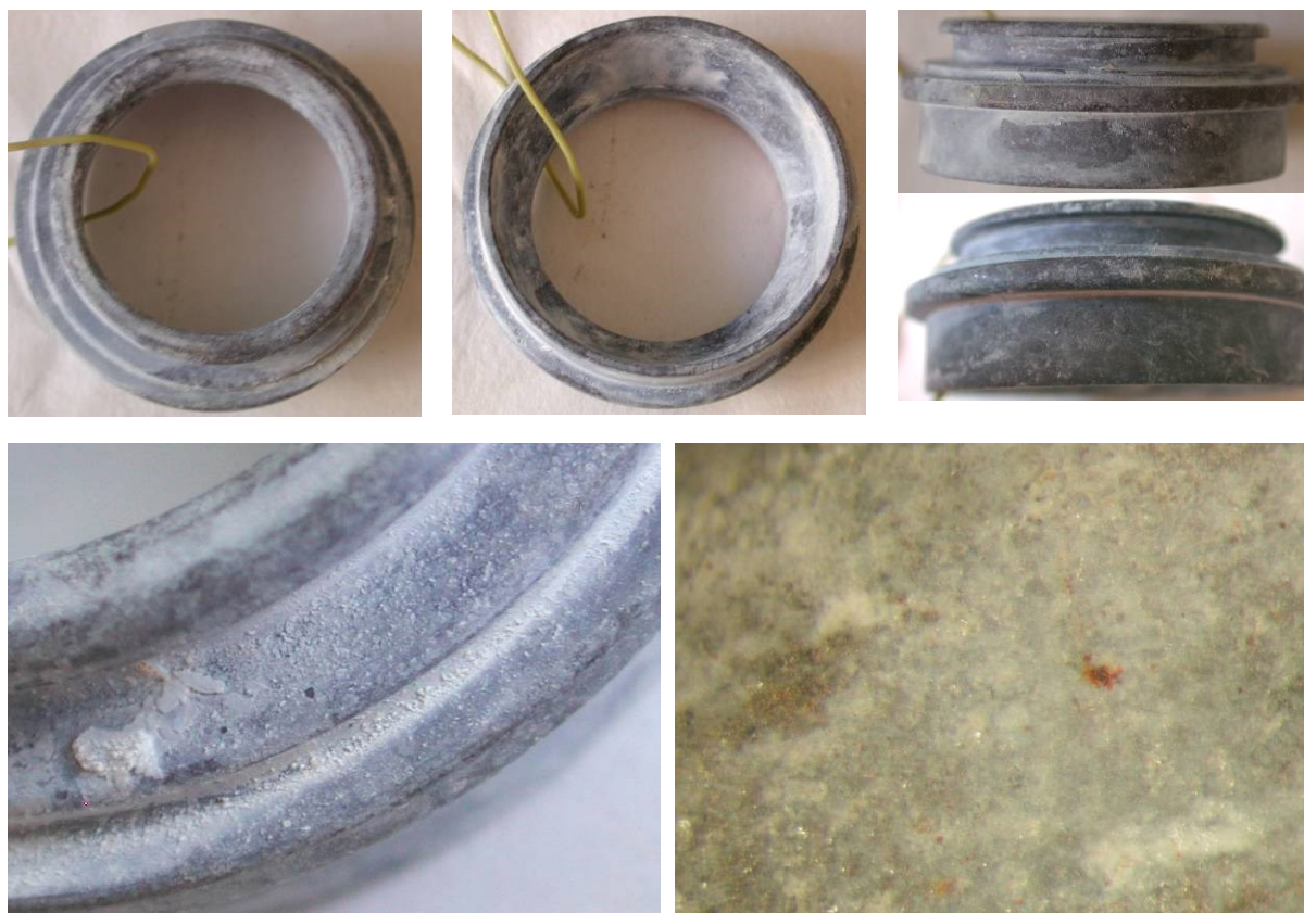
Obrázek 115 - Korozní napadení vzorků N3 a N4 po 2016 h expozice v NSS
