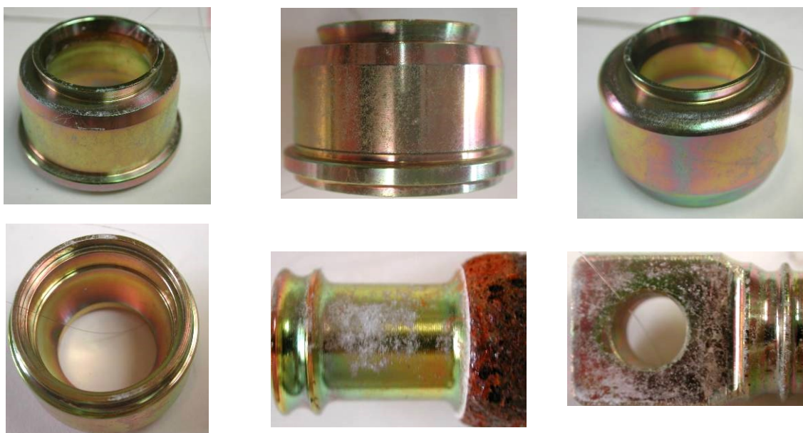
Obrázek 75 - Korozní napadení vzorků po 30 cyklech zkoušky
