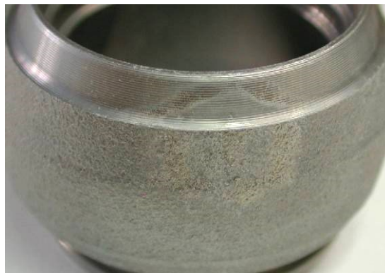
vzorek K - bílo-šedé korozní produkty slitinového povlaku
