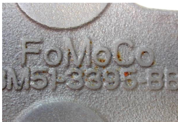
Obrázek 121 - Korozní napadení vzorku H po 50 cyklech zkoušky - detaily
