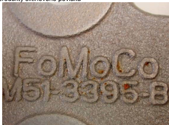
vzorek L bodové korozní napadení slitinového povlaku - korozní napadení podkladové oceli vzorek H
