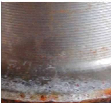
Obrázek 120 - Korozní napadení vzorku G po 50 cyklech zkoušky - detaily
