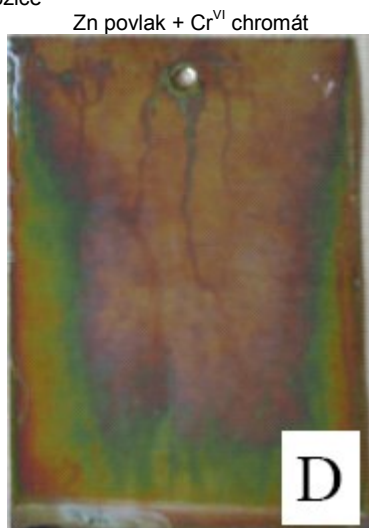
Obrázek 61 - Vzhled vzorků s konverzními povlaky ve zkoušce NSS dle ČSN EN ISO 9227
