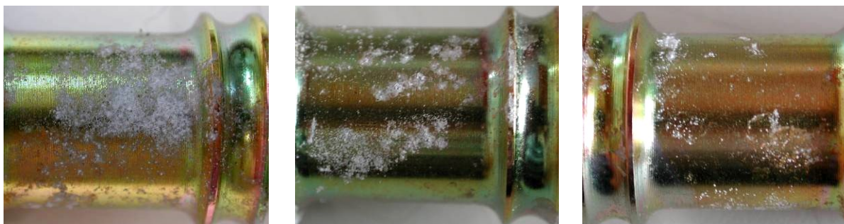
Obrázek 79 - Korozní napadení vzorku E po 50 cyklech zkoušky
