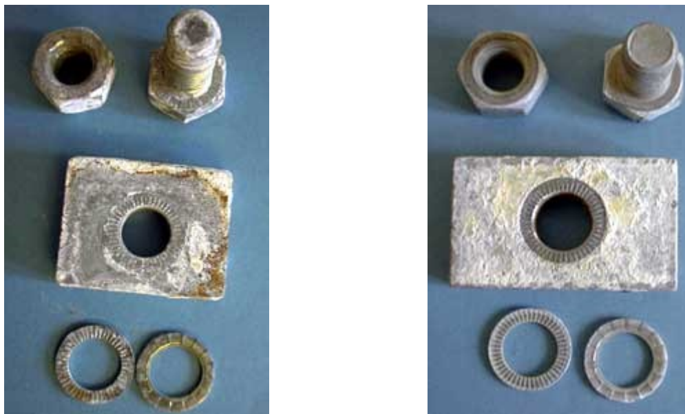
duhový chromátový povlak na zinkovém povlaku 144 h
