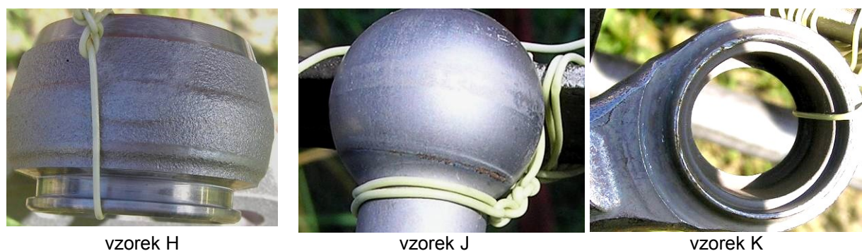
Obrázek 127 - Korozní napadení vzorků po 3 měsících expozice na atmosférické stanici
