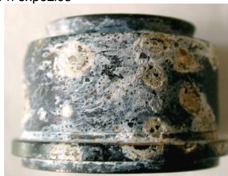
Obrázek 72 - Detaily korozního napadení vzorku po korozní zkoušce (25x zvětšeno)
