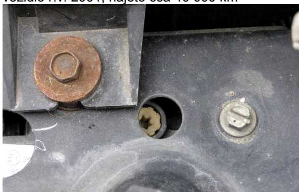
Obrázek 1 - Korozní napadení spojovacích dílů v motorovém prostoru automobilu
