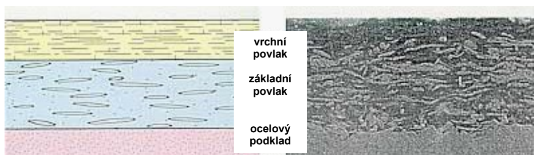
Obrázek 47 - Struktura mikrolamelového povlaku
