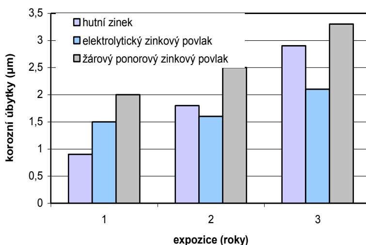
Obrázek 7 – Korozní odolnost různých zinkových povlaků v průmyslové atmosféře
