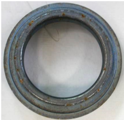
Obrázek 123 - Korozní napadení vzorku N po 50 cyklech zkoušky - detaily
