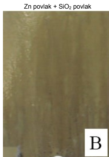
Obrázek 59 - Korozní odolnost konverzních povlaků ve zkoušce NSS dle ČSN EN ISO 9227
