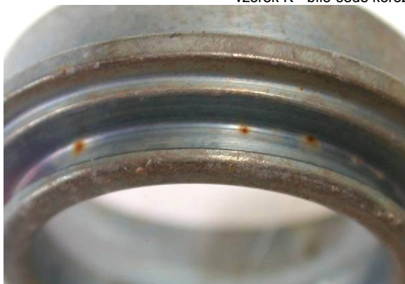
vzorek L bodové korozní napadení slitinového povlaku - korozní napadení podkladové oceli vzorek H
