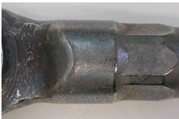
Obrázek 122 - Korozní napadení vzorku K po 50 cyklech zkoušky - detaily
