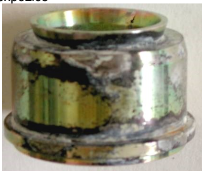
Obrázek 72 - Detaily korozního napadení vzorku po korozní zkoušce (25x zvětšeno)
