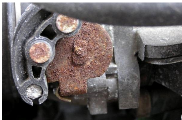
Obrázek 1 - Korozní napadení spojovacích dílů v motorovém prostoru automobilu
