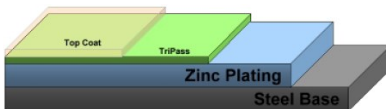
Obrázek 21 – Zinkové povlaky s pasivací a utěsněním
