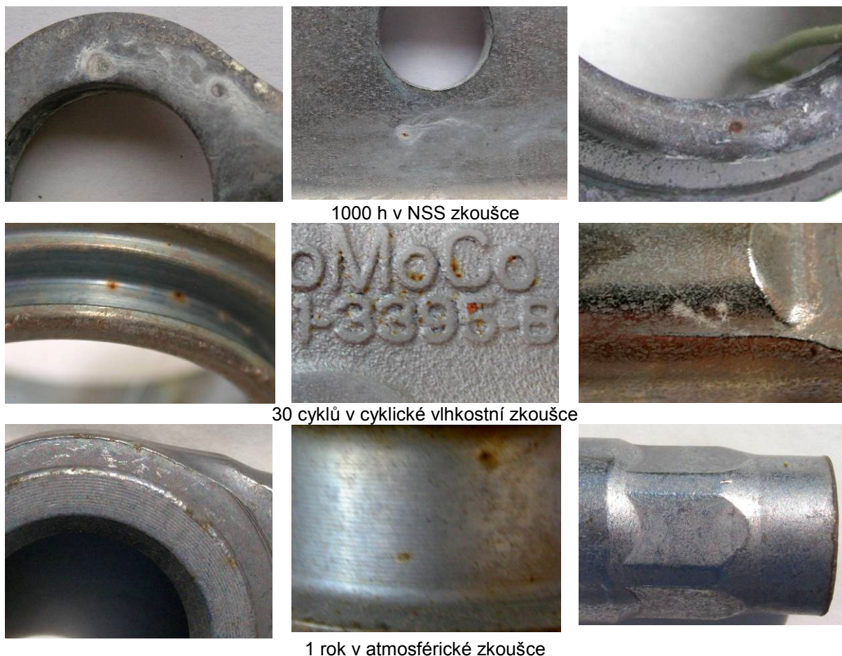
Obrázek 149 – Příklady lokálního bodového korozního napadení Zn/Ni povlaků
