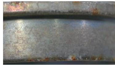
Obrázek 123 - Korozní napadení vzorku N po 50 cyklech zkoušky - detaily
