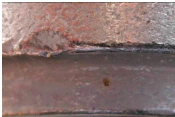
Obrázek 122 - Korozní napadení vzorku K po 50 cyklech zkoušky - detaily
