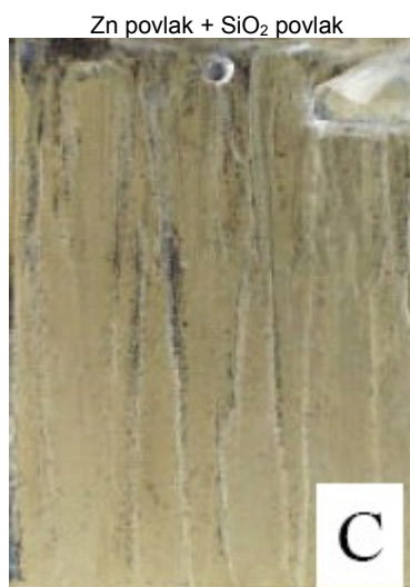
Obrázek 61 - Vzhled vzorků s konverzními povlaky ve zkoušce NSS dle ČSN EN ISO 9227
