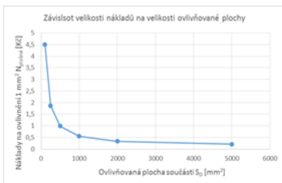
Obrázek 14 Závislost velikosti nákladů na ovlivnění 1 \text{ mm}^2 na velikosti ovlivňované plochy
