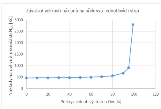
Obrázek 12 Závislost velikosti nákladů na ovlivnění výrobku na překryvu jednotlivých stop laseru
