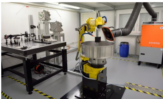
Obrázek 16 LSP stanice v Dolních březanech v centru HiLASE [10]
