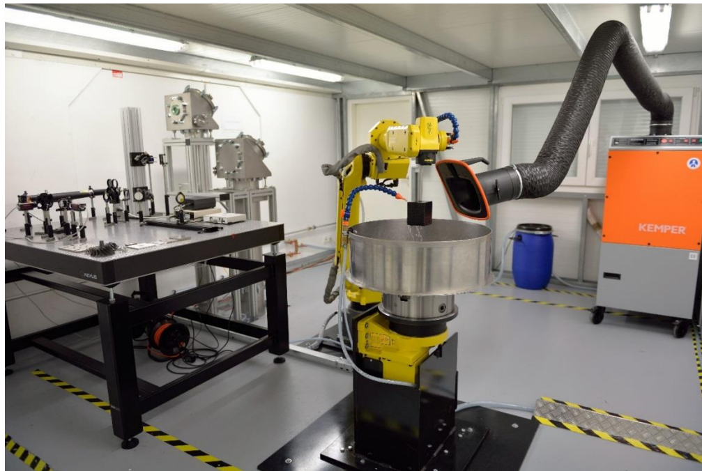
Obrázek 113 LSP stanice v Dolních březanech v centru HiLASE [251]
