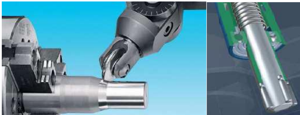
Obrázek 32 Statické vnější válečkování (vlevo) a nástroj pro dynamické vnitřní válečkování (vpravo) [94][95].
