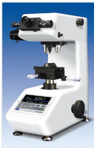
Obrázek 93 Mikrotvrdoměr Future Tech FM100 s měřením polohy, automatickým zatěžováním, CCD kamerou a odečtem vpichu
