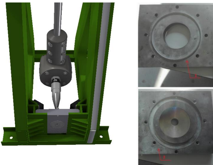
Obr. 6: Pohled na model funkční části zkušebního zařízení a systém přidržovače a tažnice
