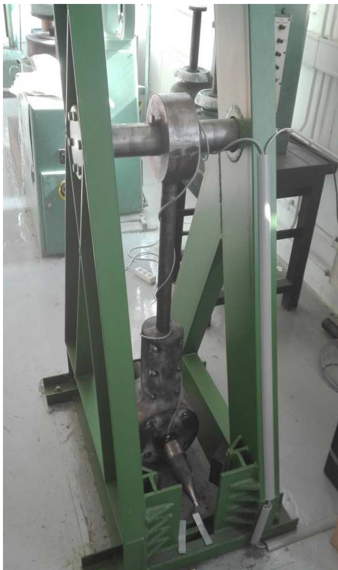
Obr. 15: Celkový pohled na navrhované zkušební zařízení
