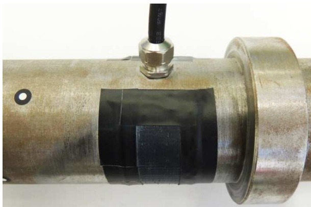
Obr. 25: Upevnění polovodičového tenzometru na nástroji
