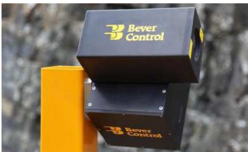
Obr. 2.8: Laserový zaměřovač – tzv. profiler používaný pro navigaci [23]
