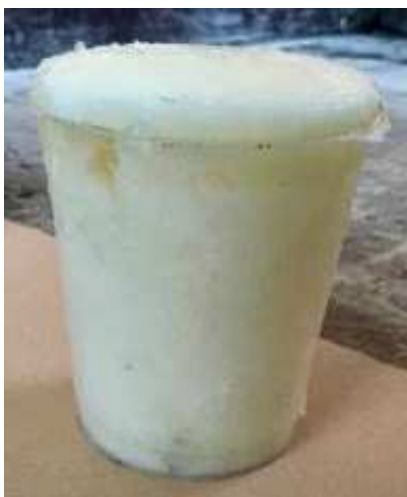
Obr. 3.4: Narůstání objemu emulze během procesu proplynění [23]
