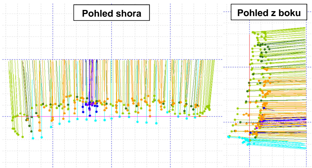
Obr. 2.15: Geometrie vrtů při vrtání na referenční rovinu [19]
