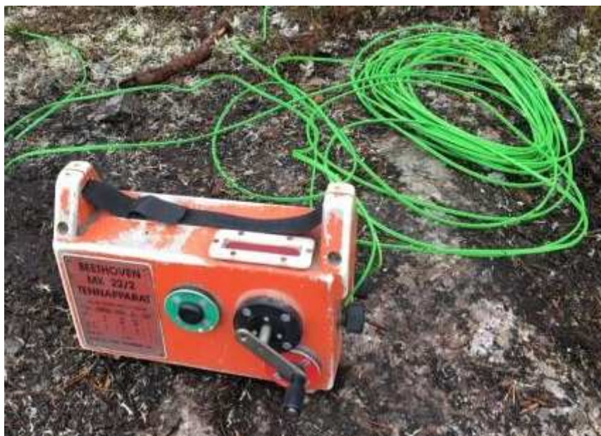
Obr. 2.24: Roznětnice Beethoven MK 22/2 s připojenou dvojlínkou elektrických vodičů [23]
