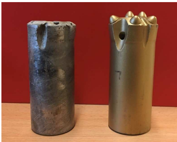
Obr. 2.18: Srovnání silně opotřebené a nové vrtné korunky [23]
