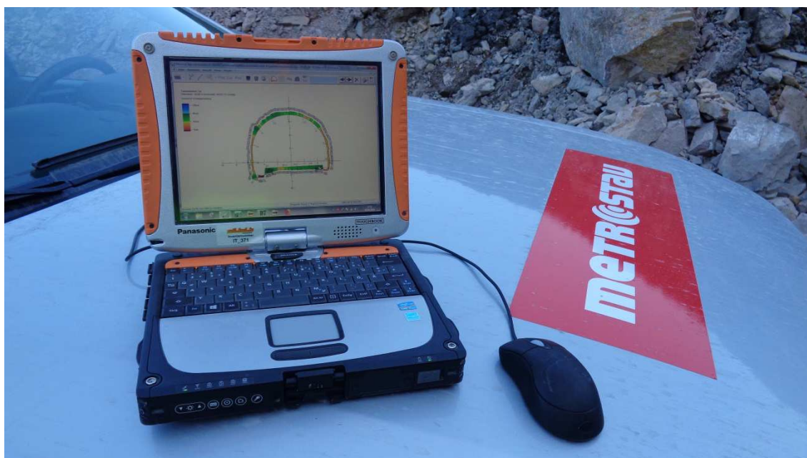
Obr. 4.3: Vyhodnocování dat ze skenování přímo na stavbě [23]
