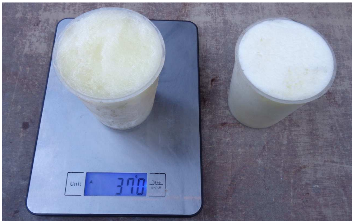
Obr. 3.3: Vážení normovaného kelímku s emulzí pro určení její hustoty [23]
