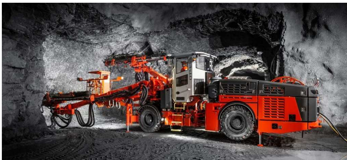
Obr. 1.2: Vrtná souprava Sandvik DT 922i při vrtání čelby pro odpal [30]
