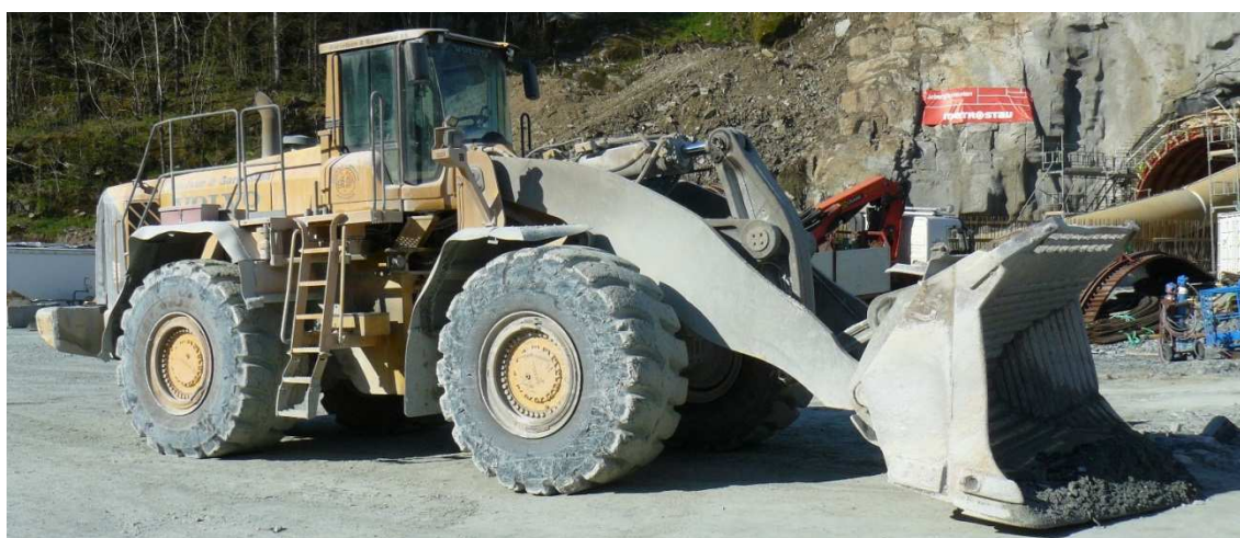
Obr. 2.28: Kolový nakladač Volvo L350F se lžící s bočním výsypem [23]
