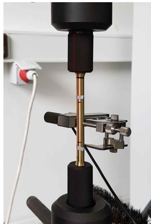
b) Vzorek upnutý v závitových čelistech s extenzometrem MSQ-R1.
