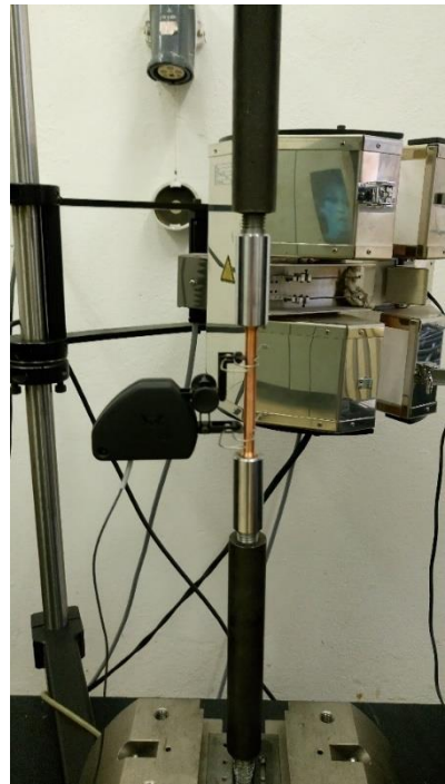
b) Vzorek upnutý v závitových čelistech s průtahoměrem
