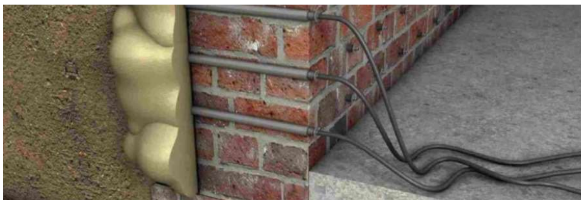
Obr. 43 Schématická ukázka rubové injektáže [18]
