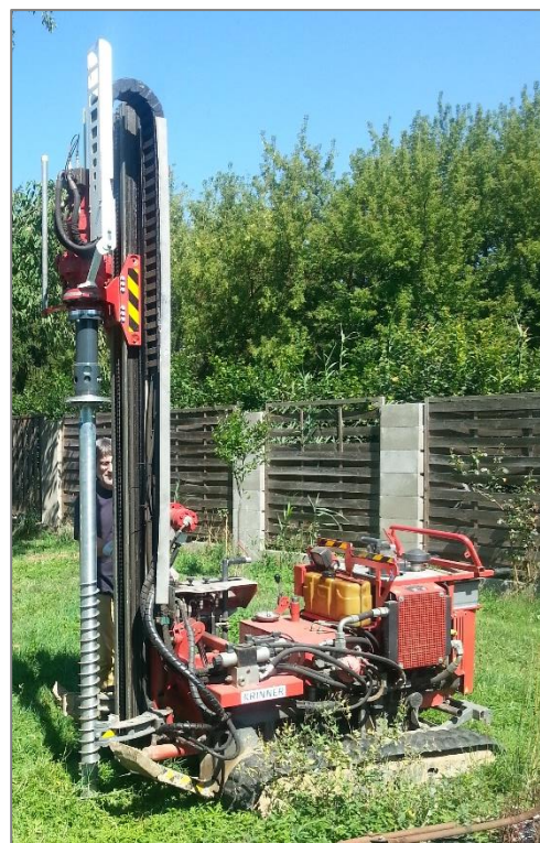
Obr. č. 34 – Pásový stroj pro zavrtání vrutů
