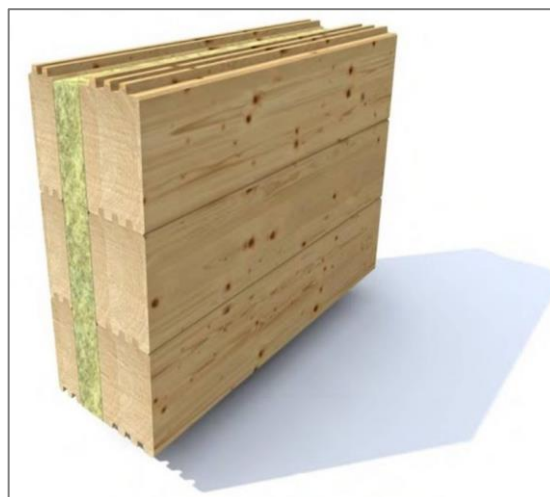
Obr. č. 8 – Dvouplášťová stěna
