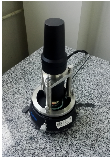
Obrázek 5.2: AFM – DME, DEN – použitý k zobrazení povrchu skloviny v této práci.
