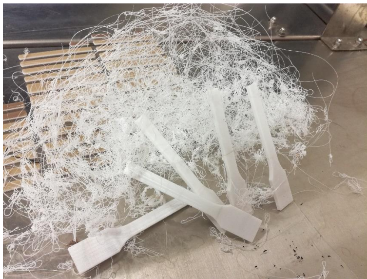
Obr. 31 – Výsledek tištění těles 1A na výšku po odstranění z vakuové fólie. Ve výšce 116,4 mm se tisk překazil a zbytek plastu se vytisknul do viditelného „chomáče“
