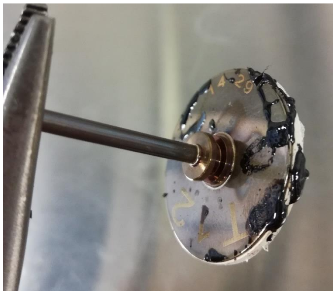
Obr. 38 – Materiál PC-ABS, proteklý mezi rozhraním kov-plast trysky T12
