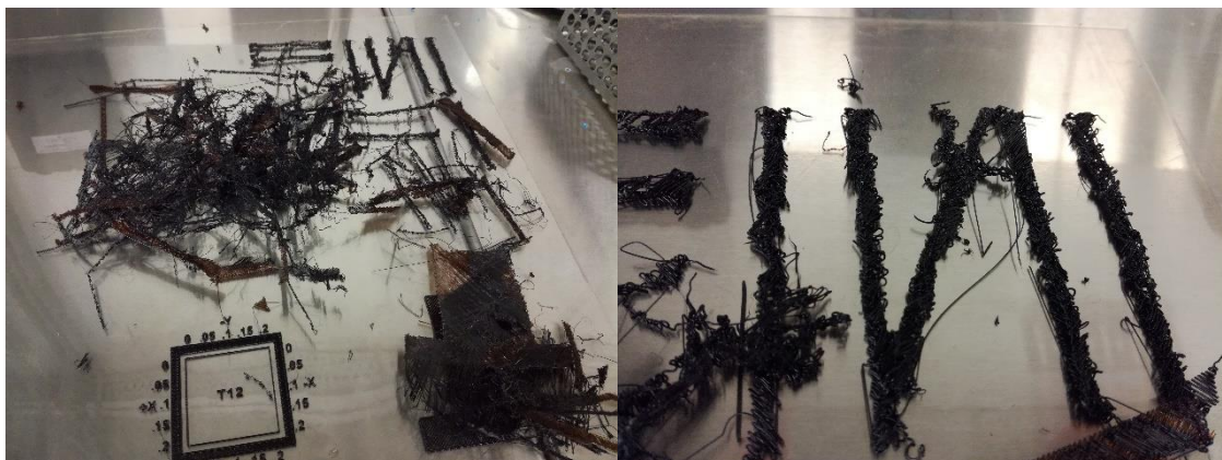
Obr. 36 – Nepodařený tisk z PC-ABS, tělesa nepřichycená k folii
