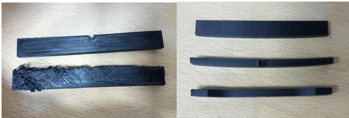
Obr. 40 – Rozdíl mezi tělesem od základny neodtrženým (nahore) a odtrženým (dole)
