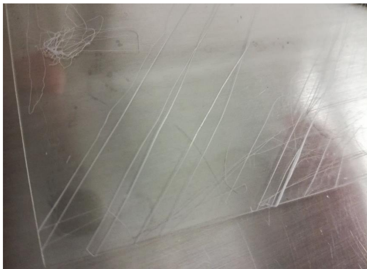
Obr. 29 – Stopy roztaveného PC na folii, nad kterou přejížděla tryska
