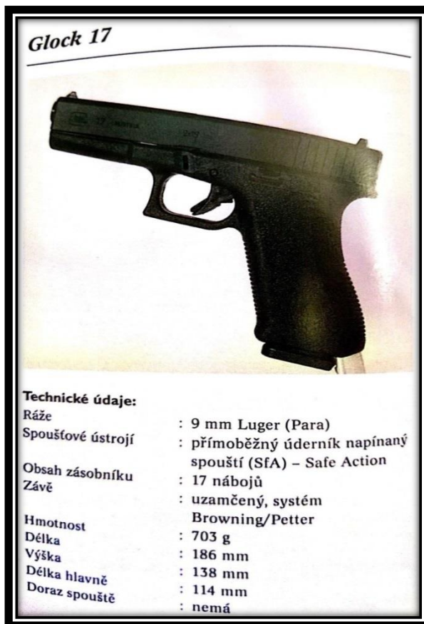
Fotografie a technická data část první pistole GLOCK 17 [14, str. 132]
