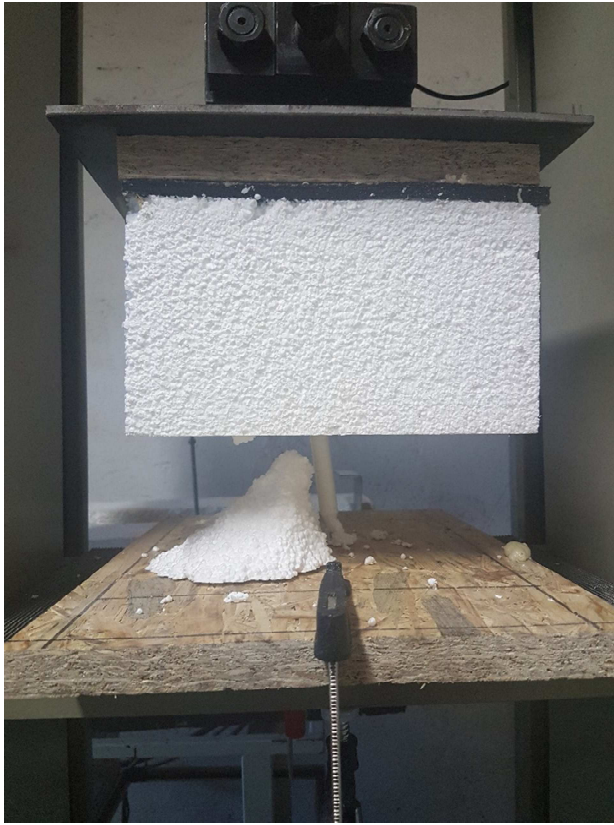
Obrázek 34 - Porušení vzorku s tl. EPS 140mm
