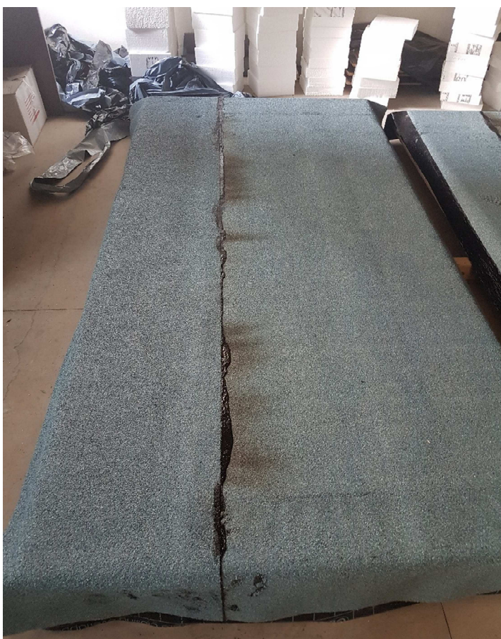
Obrázek 28 - Výsledný model po aplikaci SBS modifikovaného asfaltového pásu s břidličnatým posypem
