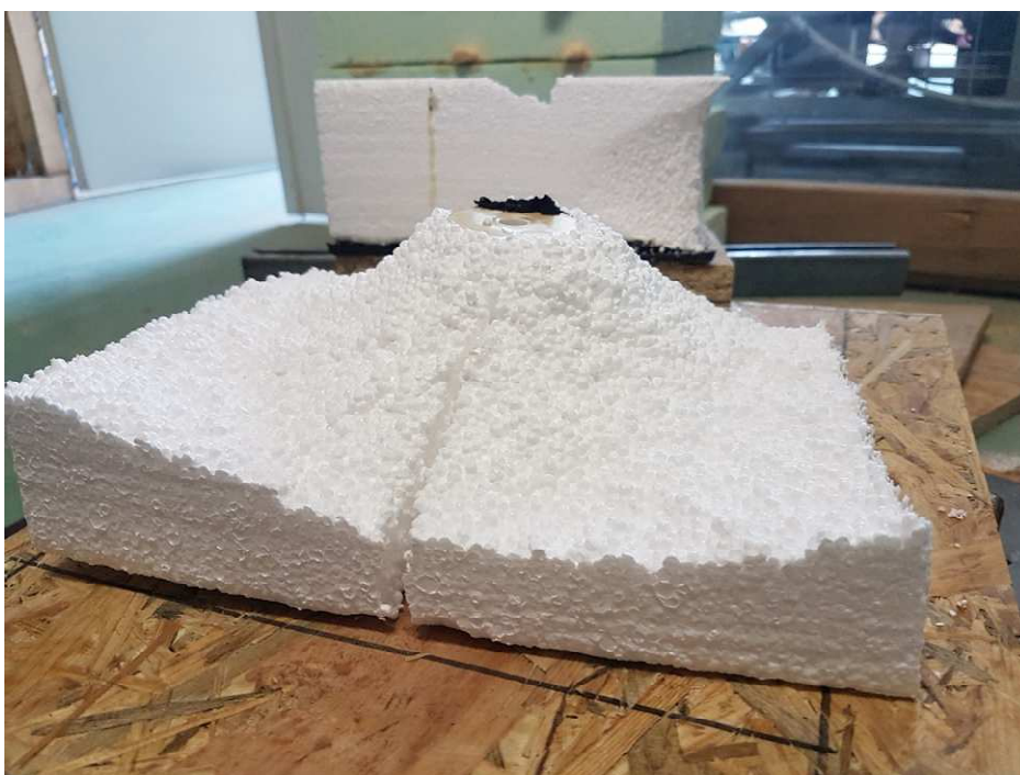
Obrázek 31 - Pohled na porušený vzorek
