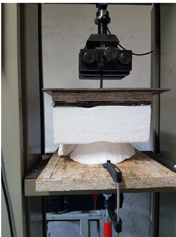
Obrázek 33 - Porušení vzorku s tl. EPS 100mm
