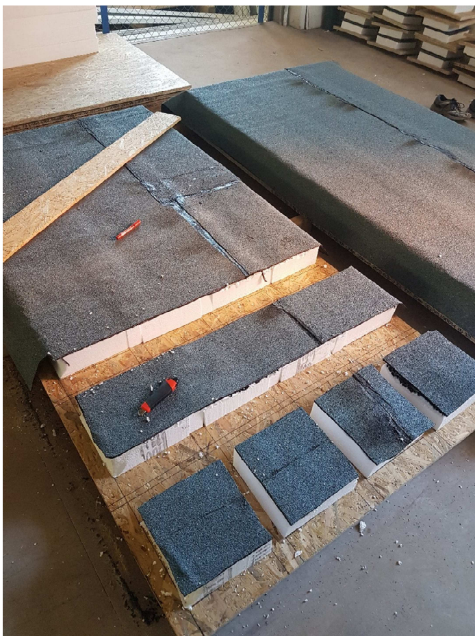
Obrázek 29 - Postupné rozřezávání na zkušební vzorky
