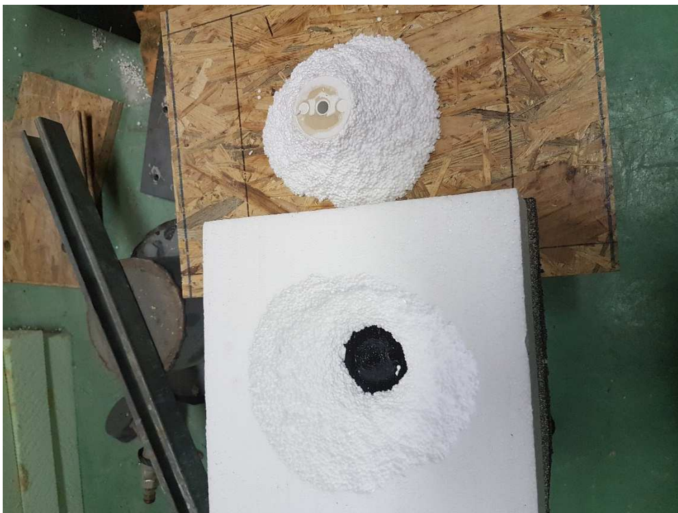
Obrázek 32 - Porušení vzorku s tl. EPS 60mm
