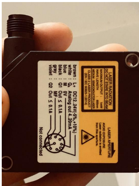
Obrázek 32 - Laser zabezpečující polohu koncového efektoru. Zdroj: konzultace Usmanov
