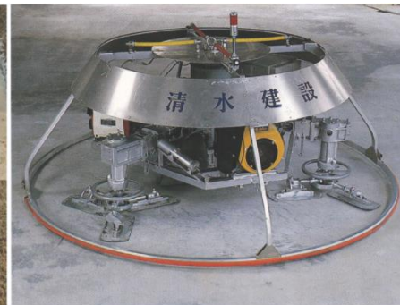
Obr.23. Robot na vyrovnání betonu; Zdroj: [22]
