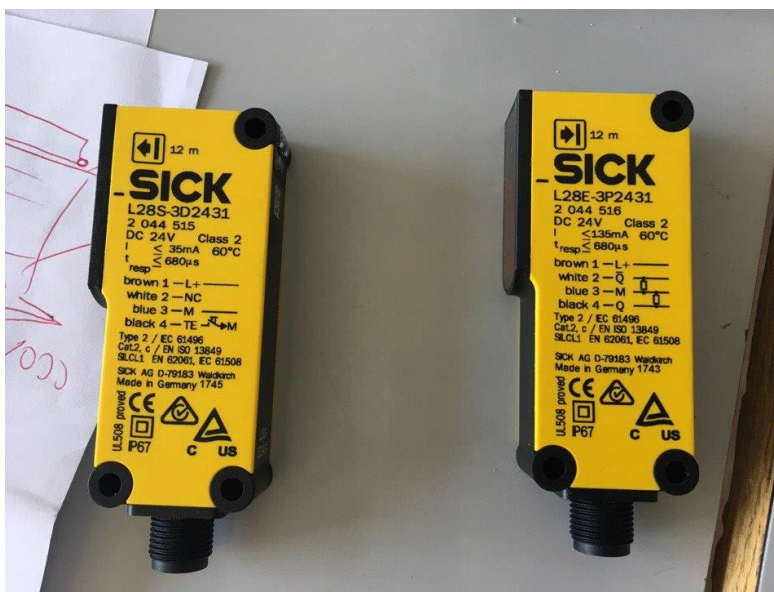
Obrázek 33 - Laser zabezpečující bezpečnost oblasti činnosti. Zdroj: konzultace Usmanov
