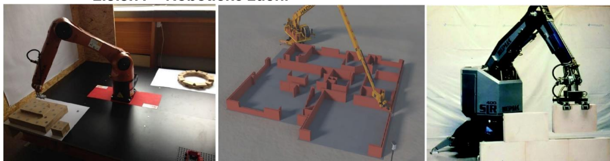
Obrázek 26 - Robotické zdění, 2017, Zdroj: [24]
