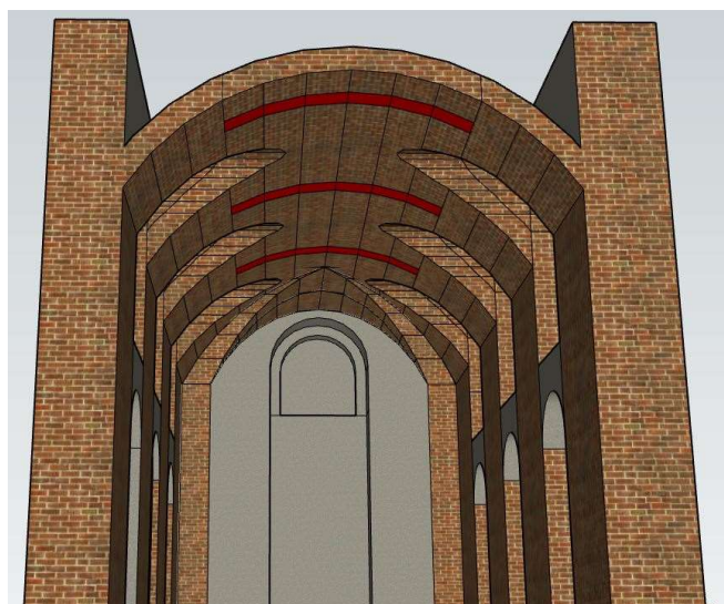
Obrázek 74– umístění pásů FRP na líc klenby [vytvořeno autorem]
