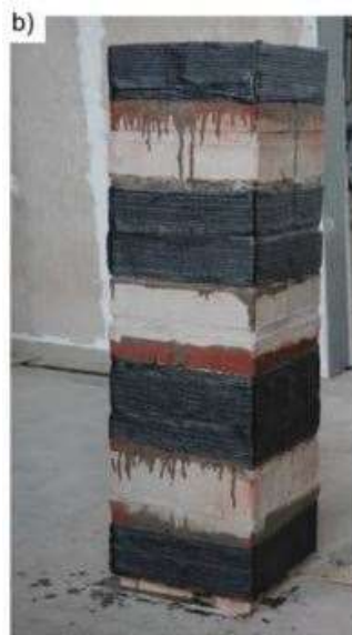
Obrázek 11– zesílený zděný pilíř [11]
