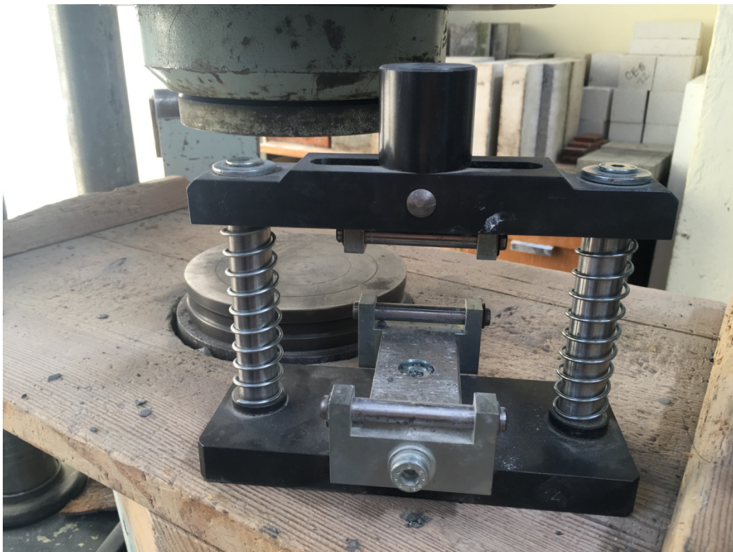
Obrázek č. 9: Ohybový přípravek BOP 15 k namáhání trámečků ohybem
