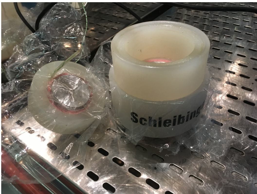
Obrázek č. 17: Připravená forma pro měření nárůstu modulu pružnosti
