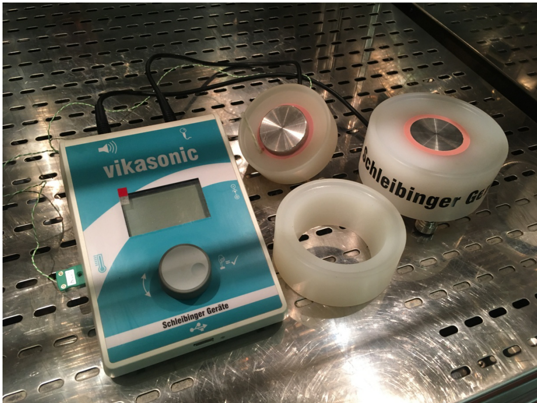
Obrázek č. 11: Ultrazvukový měřič modulu pružnosti - Vikasonic
