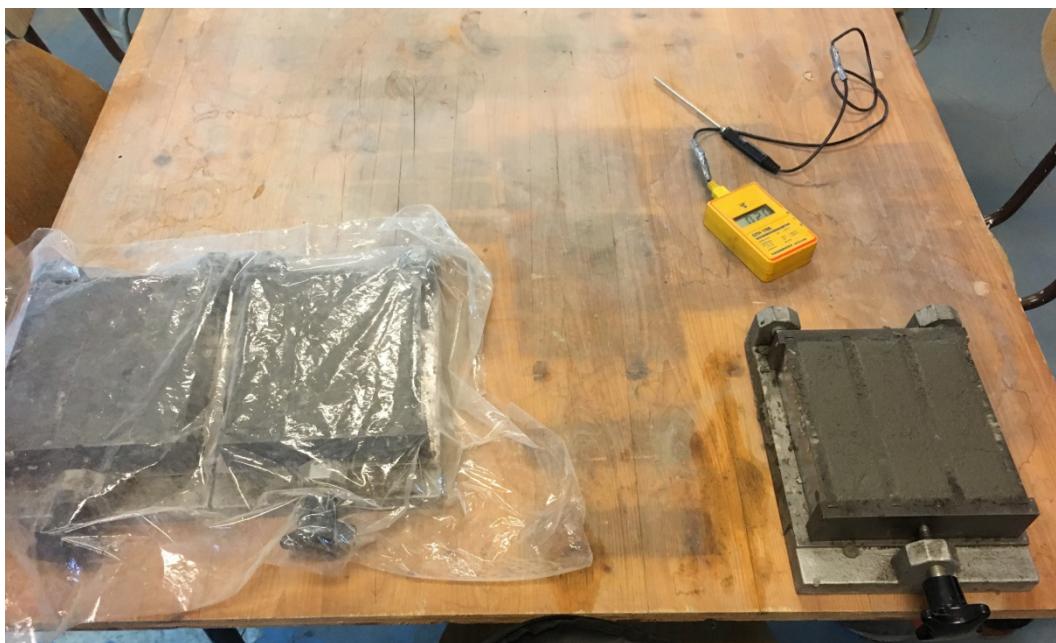
Obrázek č. 16: Příprava referenčních vzorků při laboratorní teplotě
