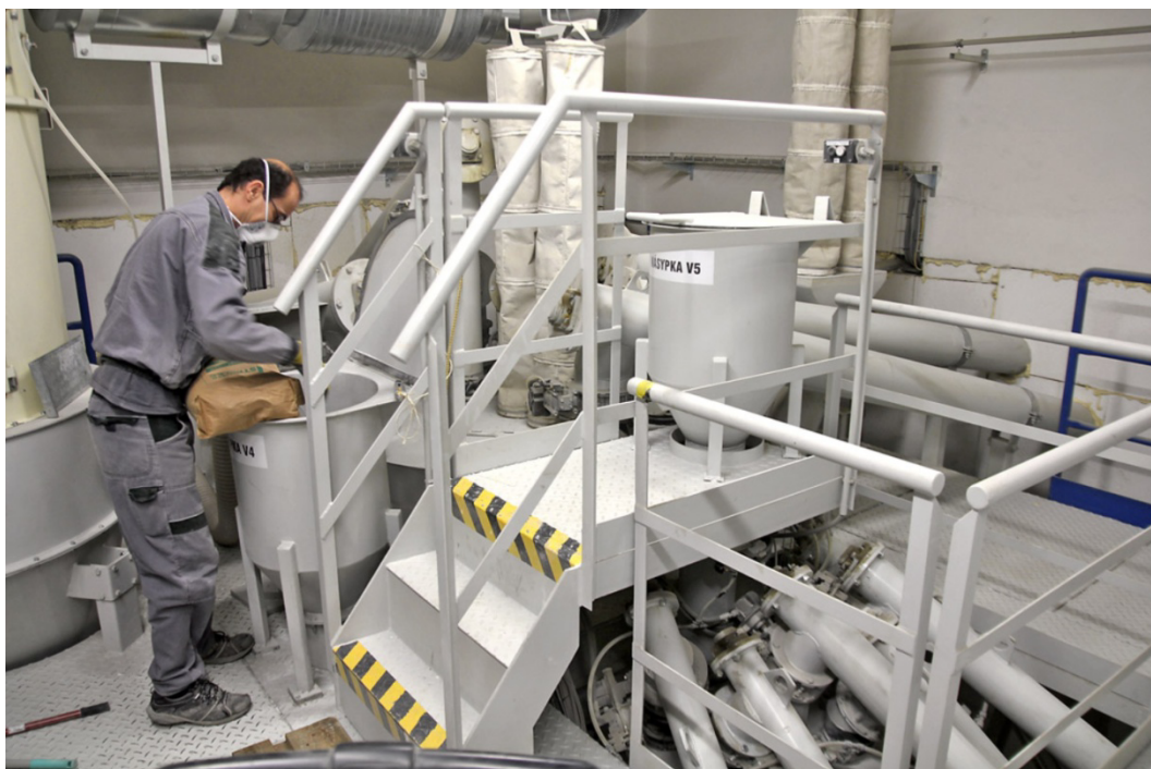
Obrázek č. 12: Výroba suché prefabrikované směsi [24]
