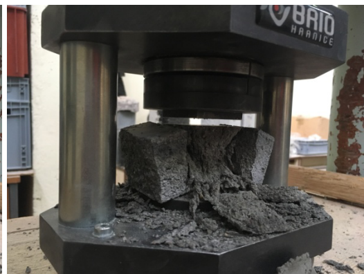
Obrázek č. 24: Porušení vzorku zatížením
