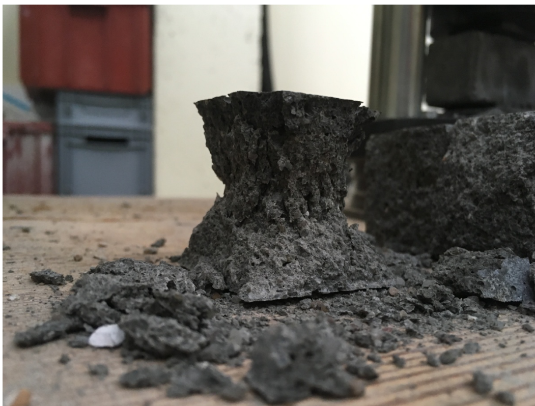
Obrázek č. 25: Ideální tvar zkoušeného tělesa po porušení
