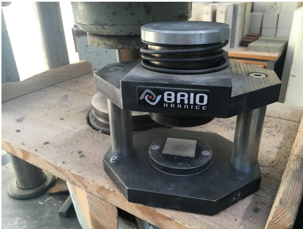
Obrázek č. 8: Tlačný přípravek BTP 300 k drcení polovin trámečků
