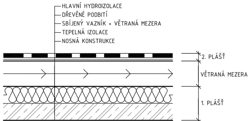
Obr. 5: Víceplášťová střecha bez pojistné hydroizolace (zdroj: vlastní)
