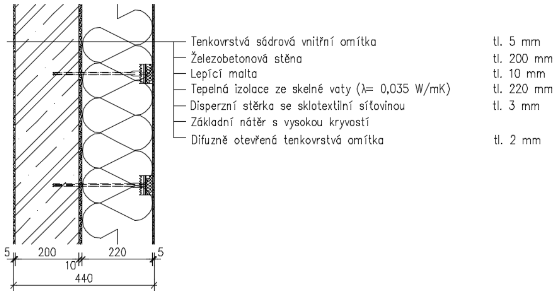
Obrázek 3 Skladba obvodového pláště - 3. varianta
