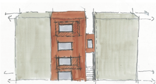
PŘEDSAZENÁ FASÁDA PŘETAŽENA PŘES VÝKLENKY HMOTY
