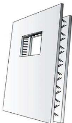
Obr. 3.21 Otvor ve filigránové stěně [25]
