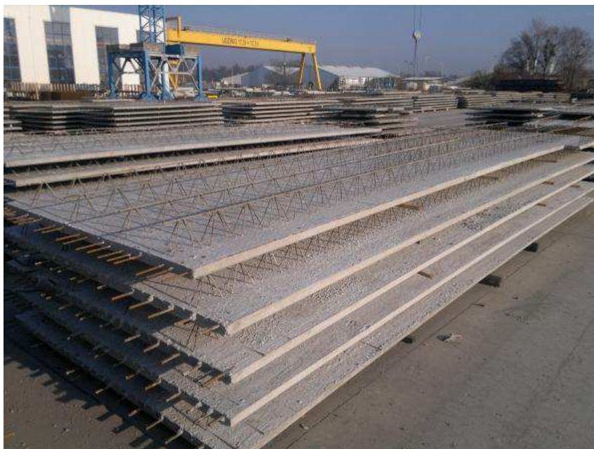
Obr. 3.9 Skladování filigránových desek s proklady [10]
