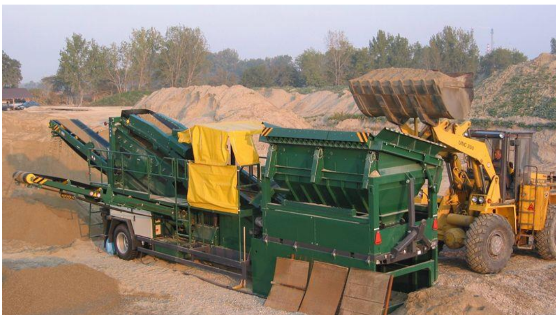
Obrázek č. 21 Recyklační souprava na semimobilním podvozku [20]
