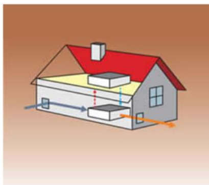
Tepelné čerpadlo vzduch/voda - ochlazuje se vzduch odváděný větracím systémem. © EkoWATT
