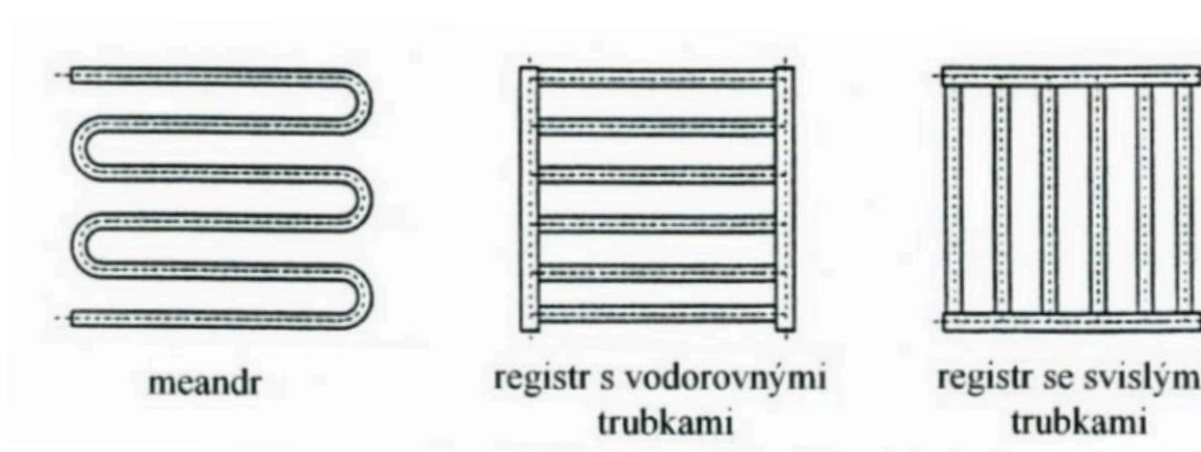
Obr. 4 Tvary trubkových otopných těles [10]
