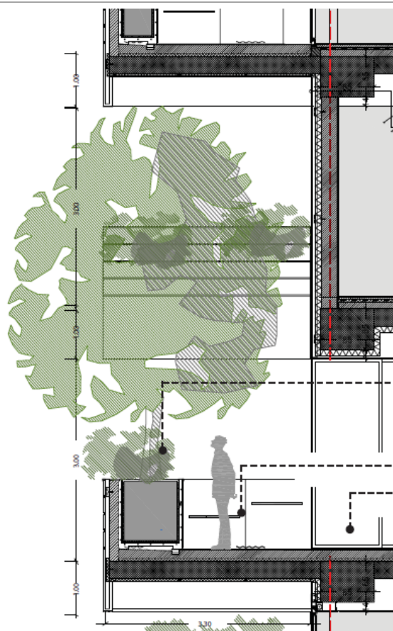
Obrázek 21 - řez fasádou s balkónem
