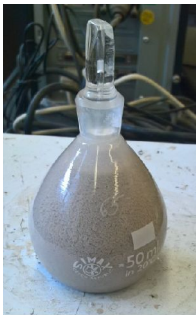
Obr. č. 25 - Pyknometr s metakaolinem a vodou
