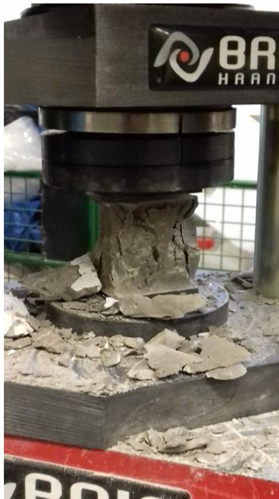
Obr. č. 29 - Porušené těleso zkouškou v tlaku
