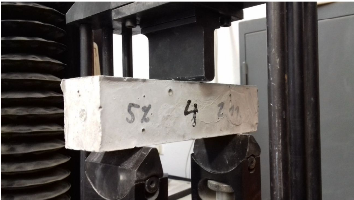
Obr. č. 27 - Trámeček tvořený s 5% náhradou popílkem uložený ve zkušebním tělese pro zjištění pevnosti v tahu za ohybu
