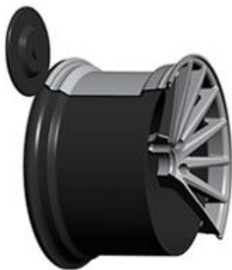
Obrázek 39: Flow Forming krok č. 4 [65]
