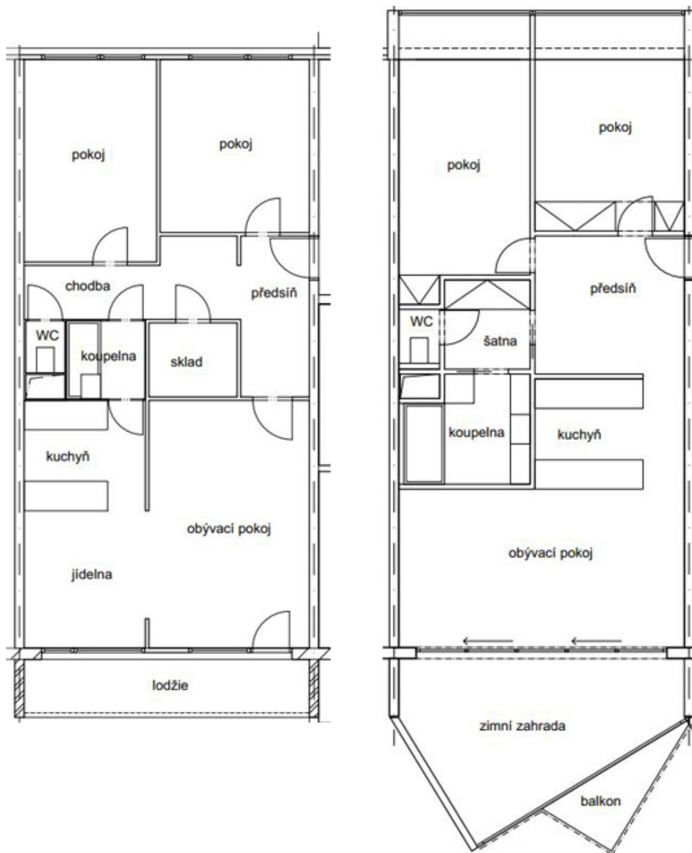
Obrázek 5.7: Půdorys původního bytu 3+1 (vlevo) v porovnání s novým navrženým stavem (vpravo)
