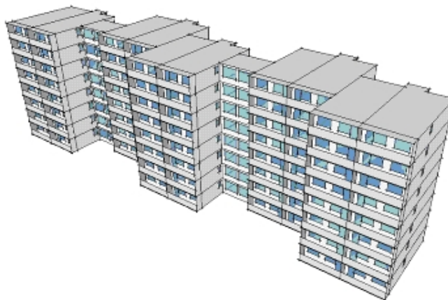
Obrázek 2.2: Stavební systém T 06 B (zdroj Ekowatt)
