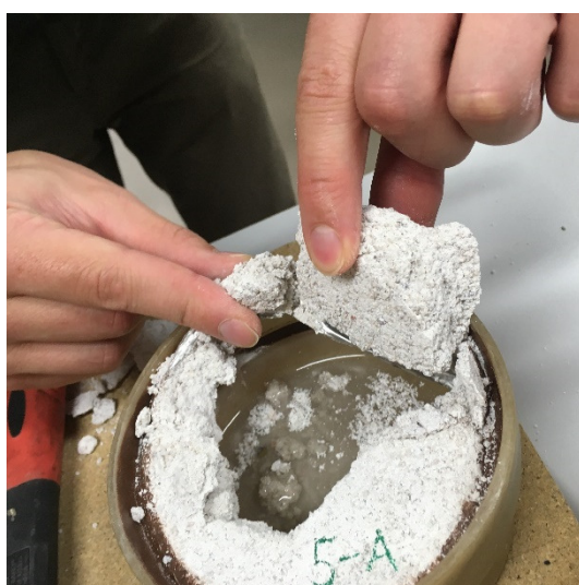
Obrázek 76 - Kontrola čistoty spodní hrany terčíku vzorku OM5
