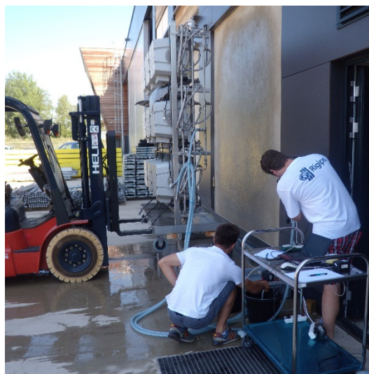
Obrázek 22 - Fotografie zachycující skrápění fasády
