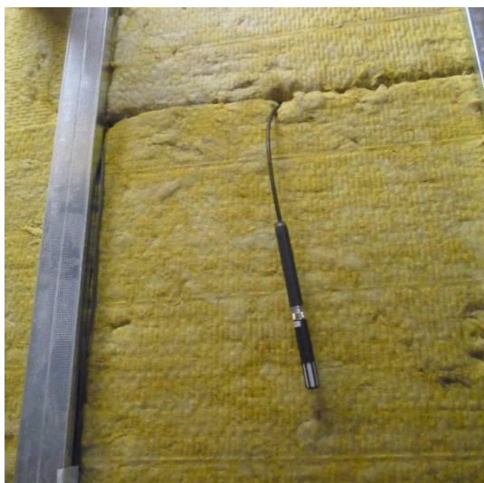
Obrázek 15 - Čidlo pro měření teploty a relativní vlhkosti ve vzduchové dutině mezi parotěsnou fólií a minerální vatou ve skladbě S2 [10]
