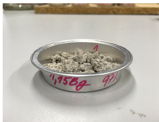
Obrázek 90 - Vzorek omítkové malty OM1 pro zkoušku stanovení sorpčních křivek
