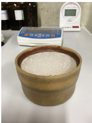
Obrázek 73 - vzorek pro zkoušky dry-cup a wet-cup
