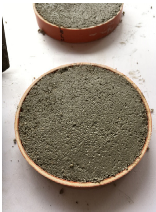
Obrázek 72 - forma pro vzorky tvaru terčků
