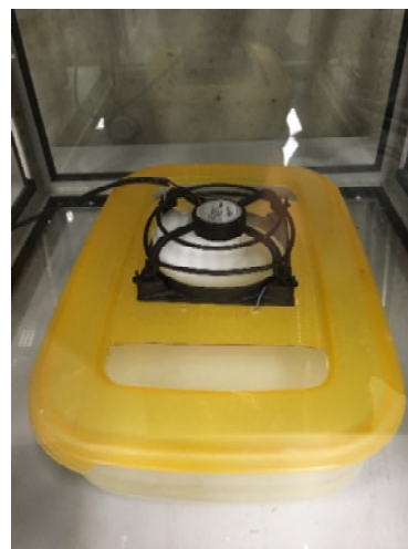
Obrázek 75 - miska s nasyceným roztokem soli
