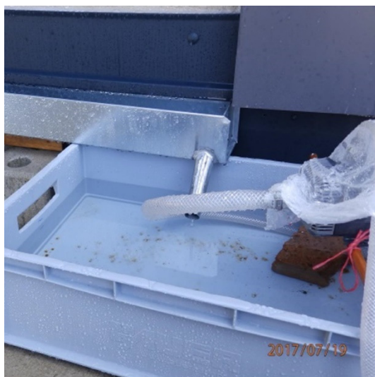
Obrázek 21 - Vyústěný okapního žlabu do přepravky osazené čerpadlem [11]
