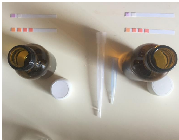
Obr. 42 Zkouška obsahu dusičnanů (fialový) a síranů (oranžový) pomocí indikačních papírků
