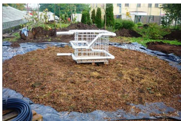
Obrázek 51 - výměník tepla uprostřed biomilíře [25]
