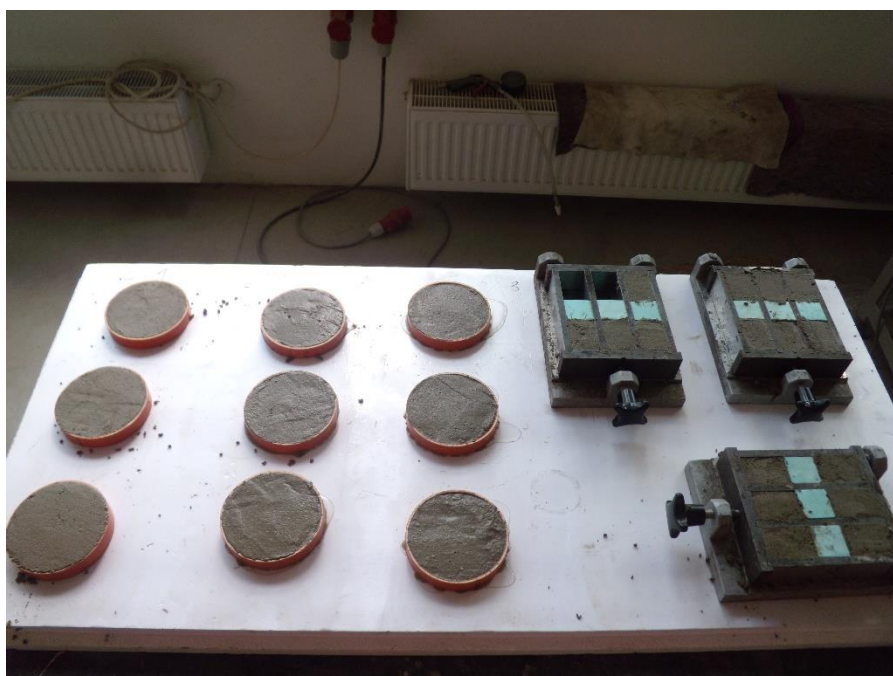
Obrázek 5.3-2: Vylití betonu do forem
