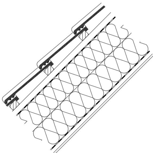
Obr. 22 : Navrhovaná úprava střešní krytiny na budově A
