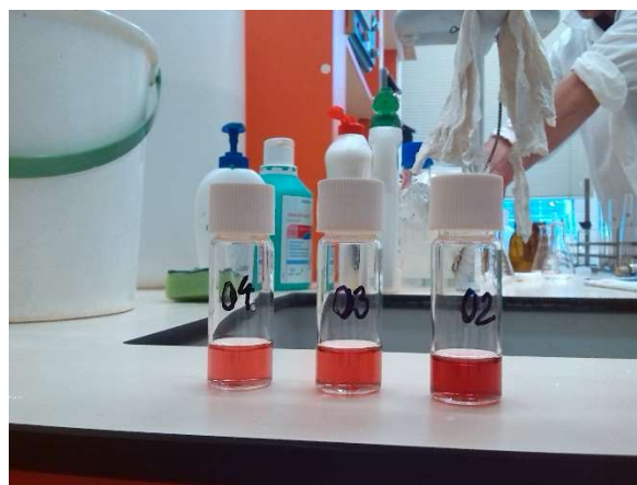
Obr. 42 – Zbarvené výluhy pro zjištění koncentrace síranů
