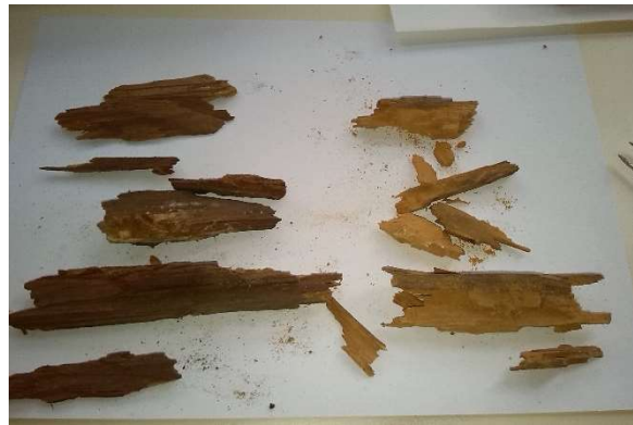
Obr. 50 – Odebrané vzorky ze zhlaví stropních trámů a z konstrukčních prvků krovu
