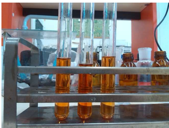
Obr. 41 – Zbarvené výluhy pro určení koncentrace chloridů
