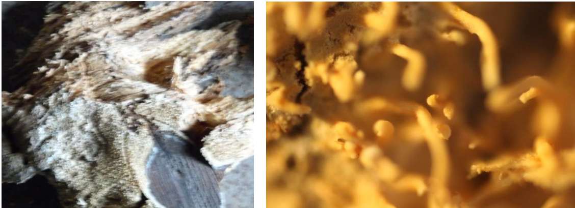
Obrázek 56,57 – Vzorek č. 8 a mikroskopické zobrazení dřevokazné houby, 2018
