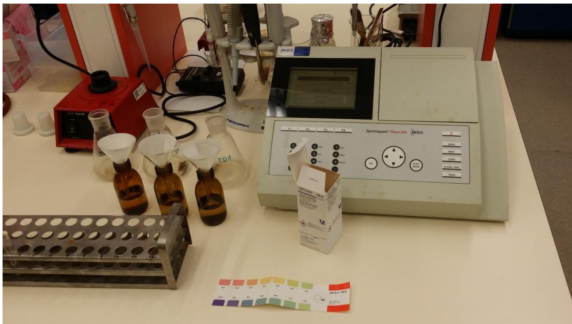
Obrázek 52 – Příprava filtrátu pro chemické zkoušky, fotometrický přístroj, 2018
