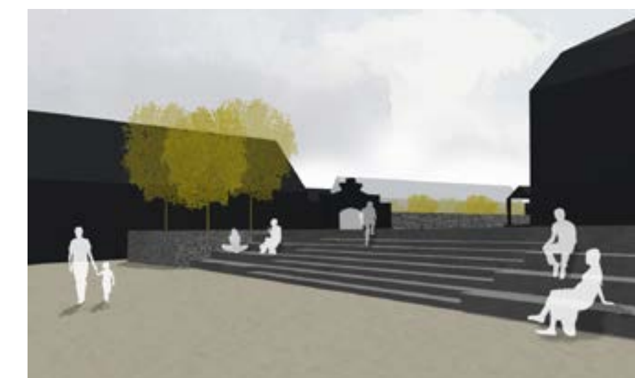
POHLED B_ schodiště vedoucí k zámku, po stranách řešeno jako sedací schody s dvojnásobnou výškou stupně
