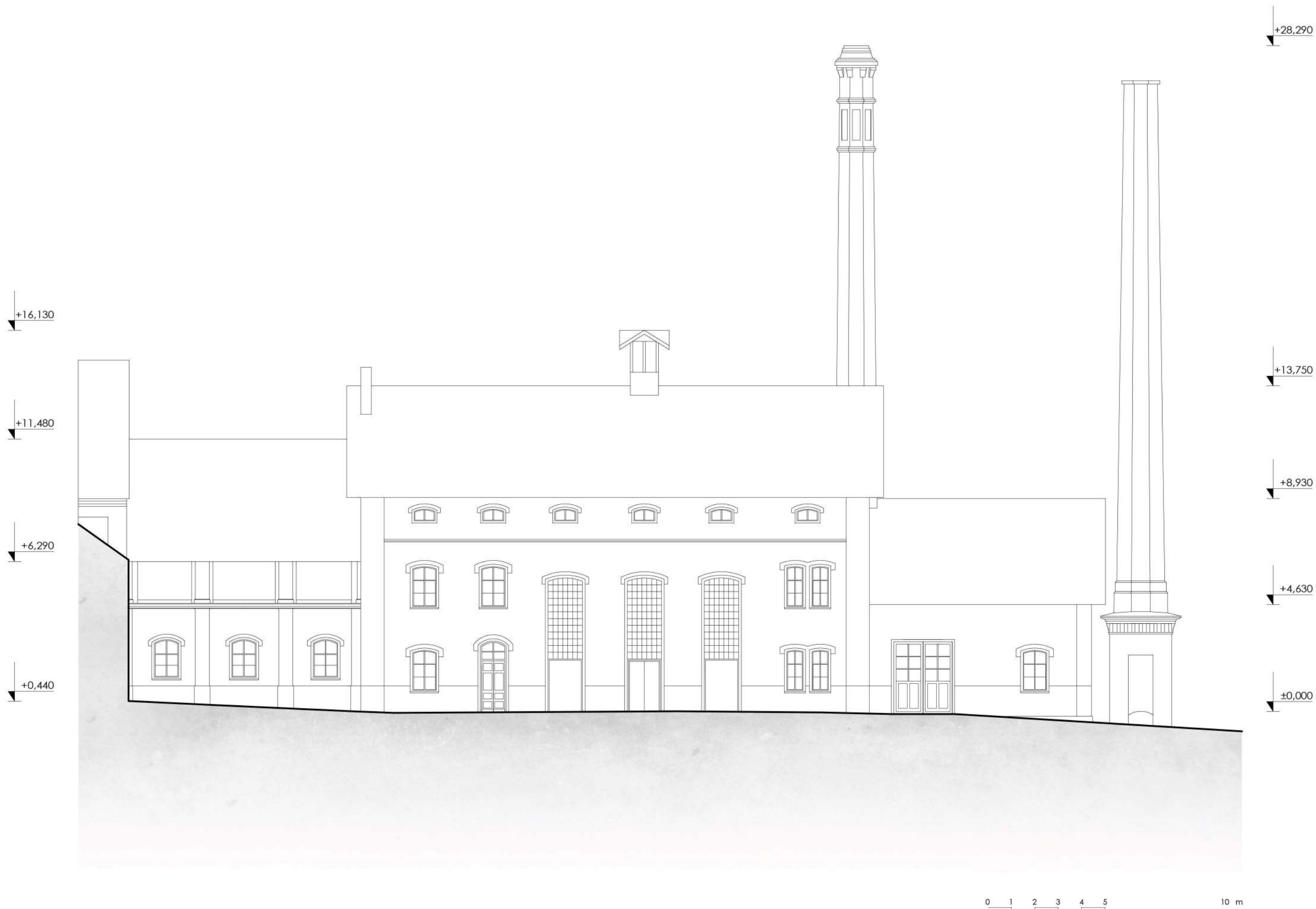
RESTAURACE S MINIPIVOVAREM - ZÁPADNÍ POHLED rekonstrukce stávajícího objektu (původní využití: pivovar), měřítko: 1:150
