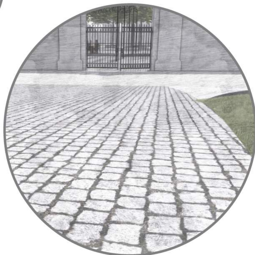
Žulové kostky 100x100 Tvoří předprostory budov
