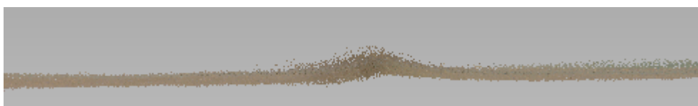
Obr. 29: Detail plotu na hustém mračnu získaného metodou SfM
