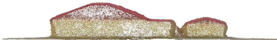
Obr. 42: Vyhodnocený objekt a zakryté místo mezi objekty UAV
