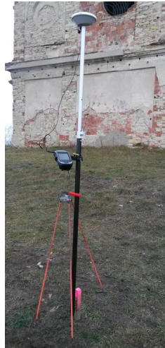
Obrázek 12: GNSS přijímač Trimble GeoXR
