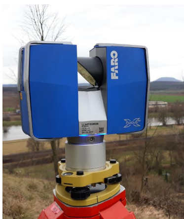
Obrázek 13: Laserový skener FARO Focus 3D X 330
