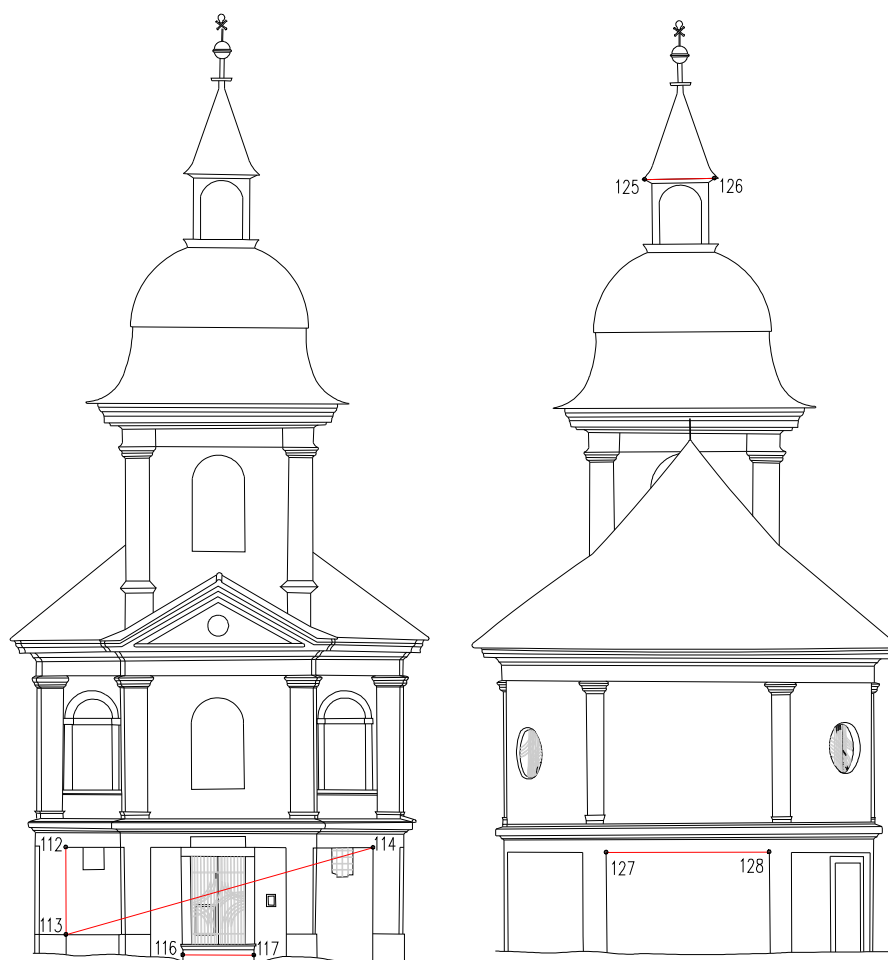
Obrázek 24: Zobrazení podrobných bodů a porovnávaných délek na fasádě
