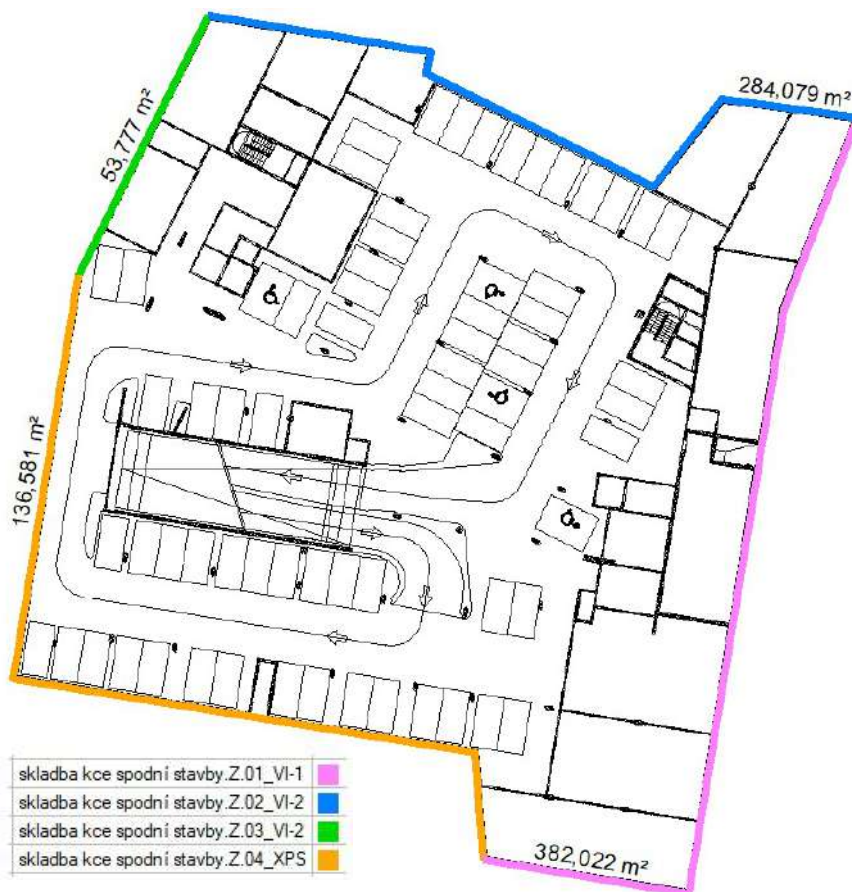
Obrázek 19: Plochy skladeb konstrukcí spodní stavby (Autodesk QTO 2013)
