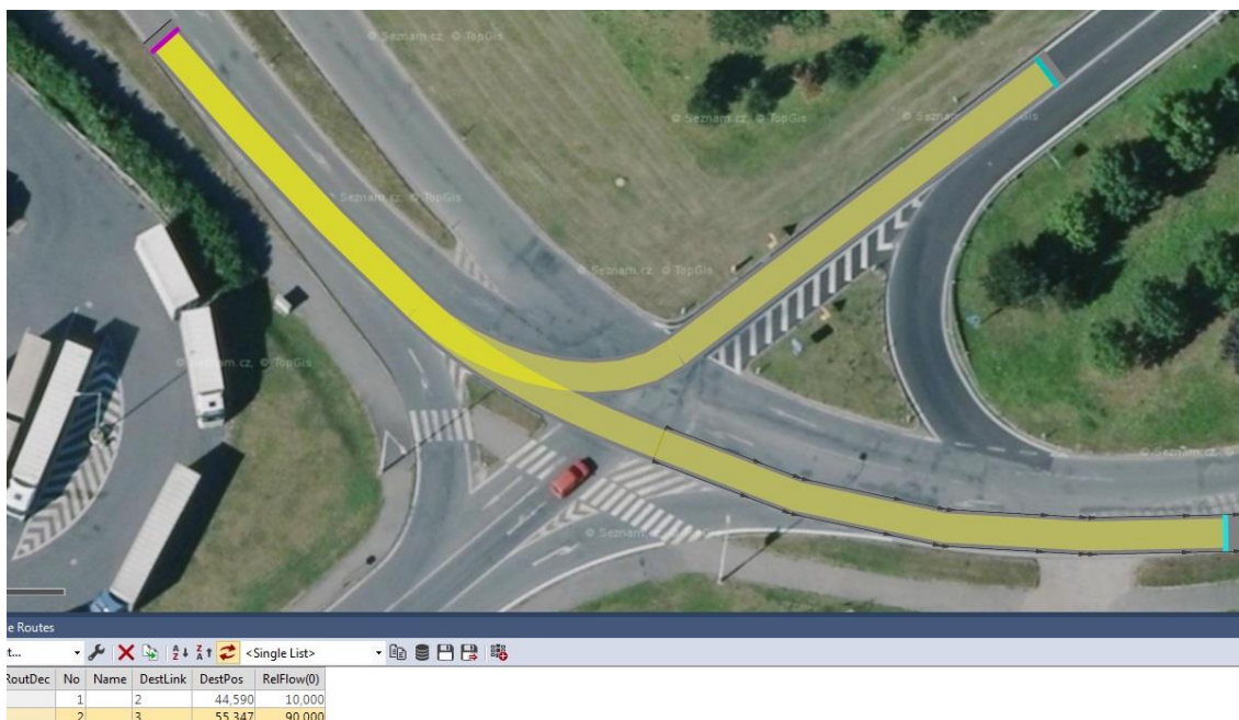
Obr.22 Zadání tras vozidel včetně procentuálního zastoupení volby dané trasy
