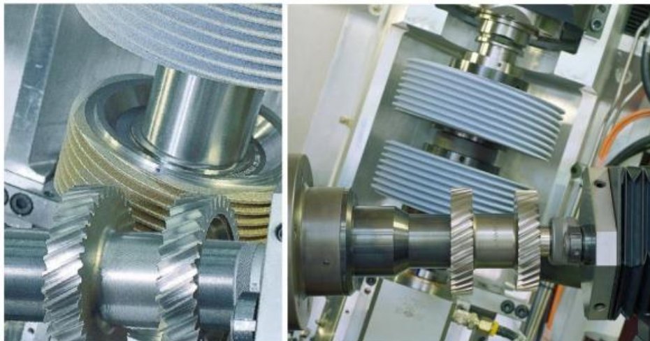
Obrázek 22. Odvalovací broušení kotoučem šnekového tvaru [4]
