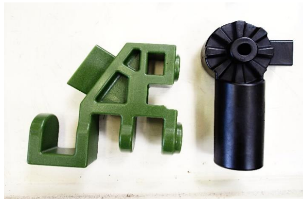
Obrázek 11: Model ze syntetického vosku (vlevo) a přírodního vosku (vpravo)
