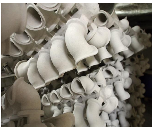
Obrázek 16: Stromečky po prvním obalu
