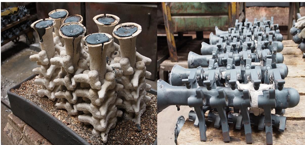
Obrázek 24: Stromečky před vibračním odstraněním keramiky (vlevo) a po jejím odstranění (vpravo)
