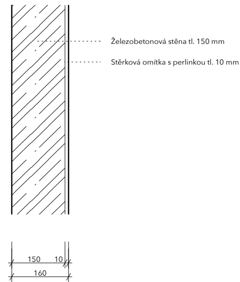
S03 Stěna 03 VNITŘNÍ NOSNÁ STĚNA M1:10
