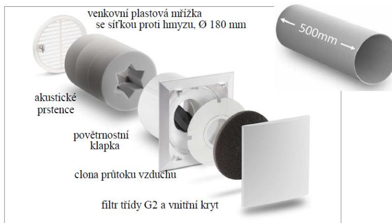
Obr. 34 - Prvek přívodu vzduchu LUNOS ALD-R160. (viz technický list, příloha PTL2)
