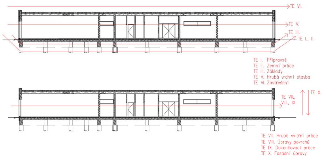
Obrázek 3: Schéma SO 02 TE 1-10
