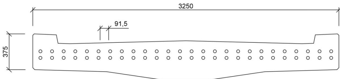
Obrázek 132: Rozmístění výztuže v řezu 20 (30).
