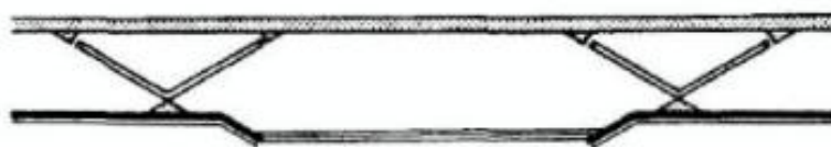
Obrázek 27: Schéma vzpěradlového rámového mostu. [1]
